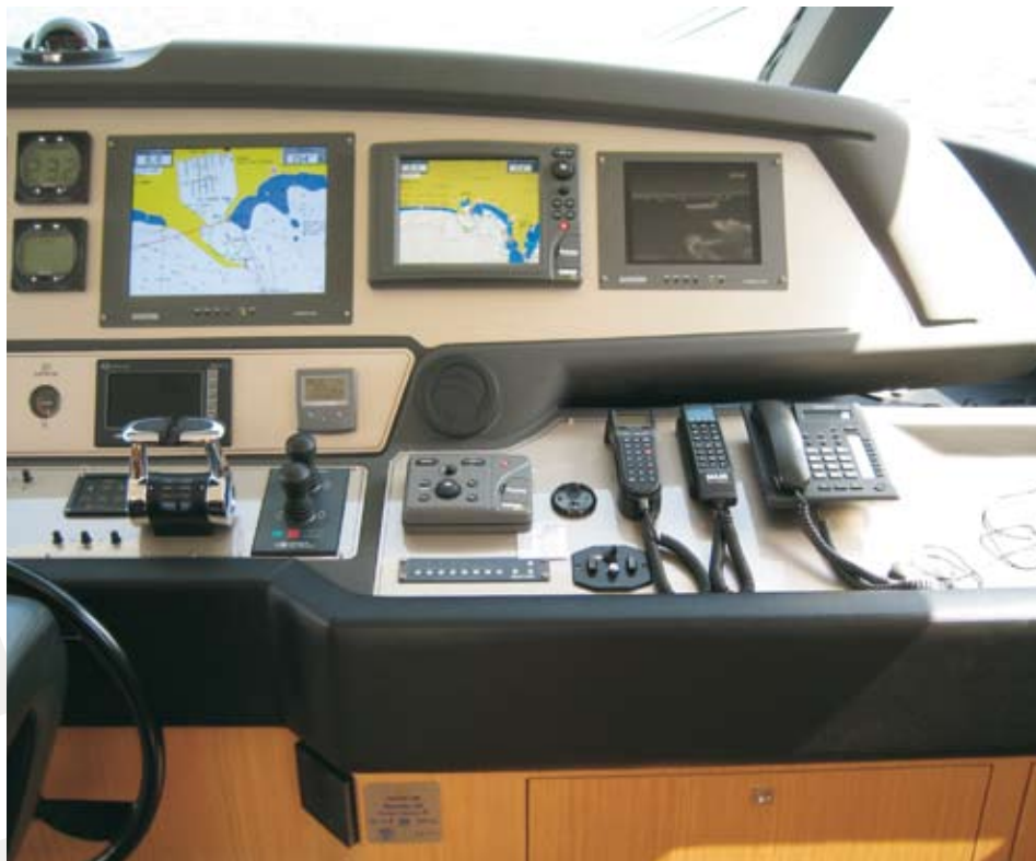
Джойстик контроля тепловизионной камеры FLIR Systems и ЖК-экран, показывающий термальные изображения, эстетично встроены в мостик
