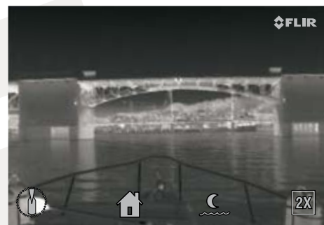
Благодаря маленьким значкам, удобно расположенным в нижней части термального изображения, капитан может сразу увидеть, в какую сторону обращена камера Navigator, и находится ли она в исходном положении. Все остальные настройки камеры также можно легко прочитать по этим значкам.
