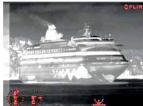
Изображение того же круизного судна, полученное тепловизионной камерой; обратите внимание на видимость окраски корпуса корабля
