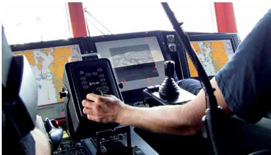
В кабине Stormbull два многофункциональных дисплея и один специализированный дисплей предоставляют трем членам команды постоянный доступ к тепловому изображению, получаемому камерой Voyager. Эргономичный модуль управления с джойстиком установлен посередине.
