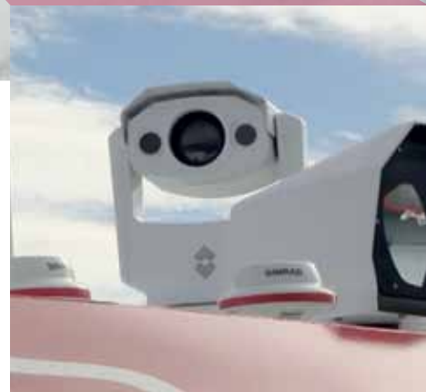
Способность видеть ночью с помощью камеры Voyager позволяет команде судна Stormbull повысить эффективность работы по спасению жизни людей.
