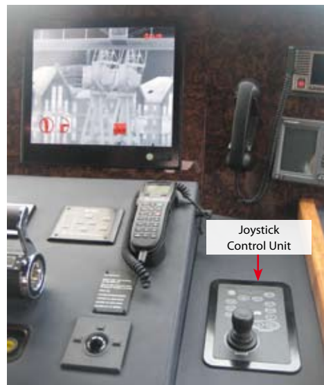
Экран, показывающий тепловизионные изображения камеры FLIR Systems Voyager на борту 34-метровой яхты Sunseeker, с пультом управления с джойстиком, эстетично встроенной в панель управления. Пульт управления с джойстиком
